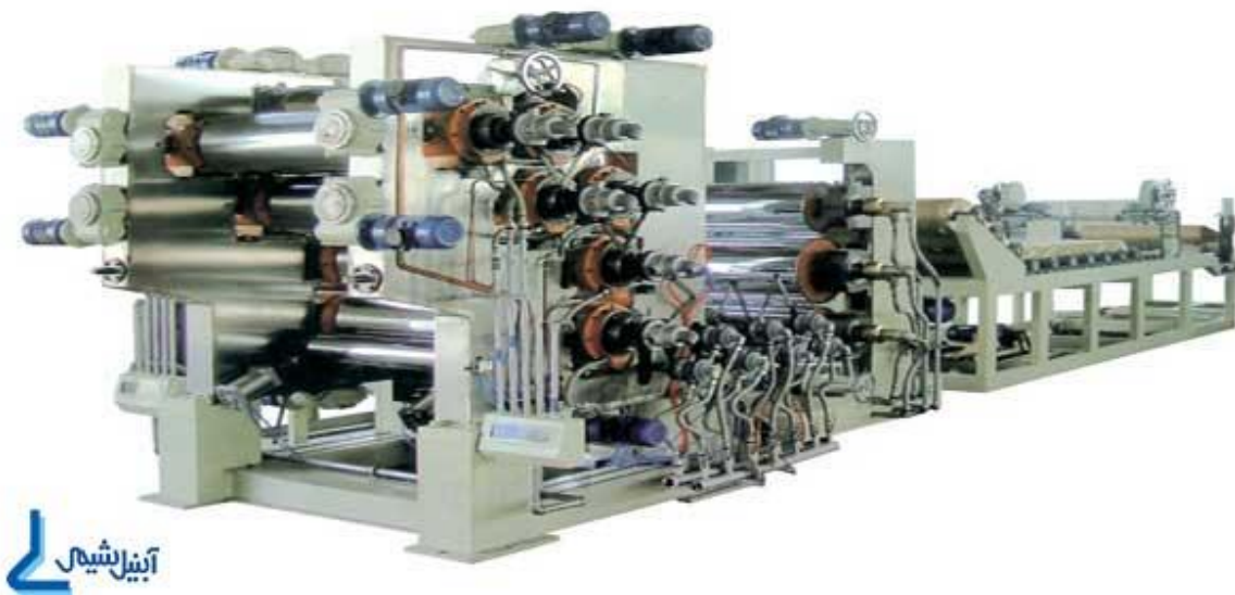
شکل دهی لاستیک توسط کلندرینگ
